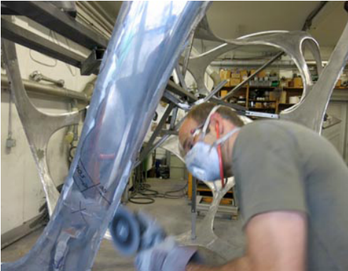
Schleifen und polieren der Oberfläche
