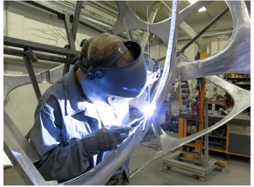
Verschweissen der inneren mit der äusseren Lage
