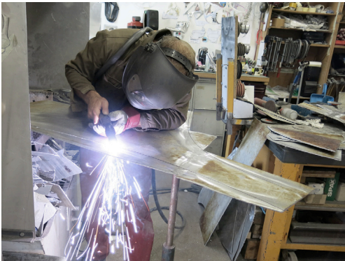
Austrennen der Einzelteile mit Plasmaschneider
