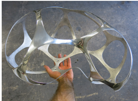
Modell 1:10 aus Aluminium, geschweisst
